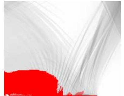
28 суток – обвал основной кровли позади забоя развивается в катастрофическом режиме
