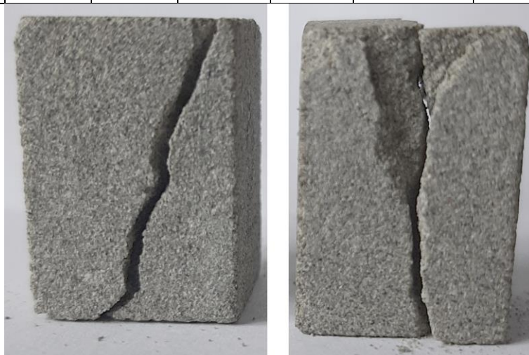
Рисунок 14 – Типичные паттерны разрушения нагруженных образцов.
