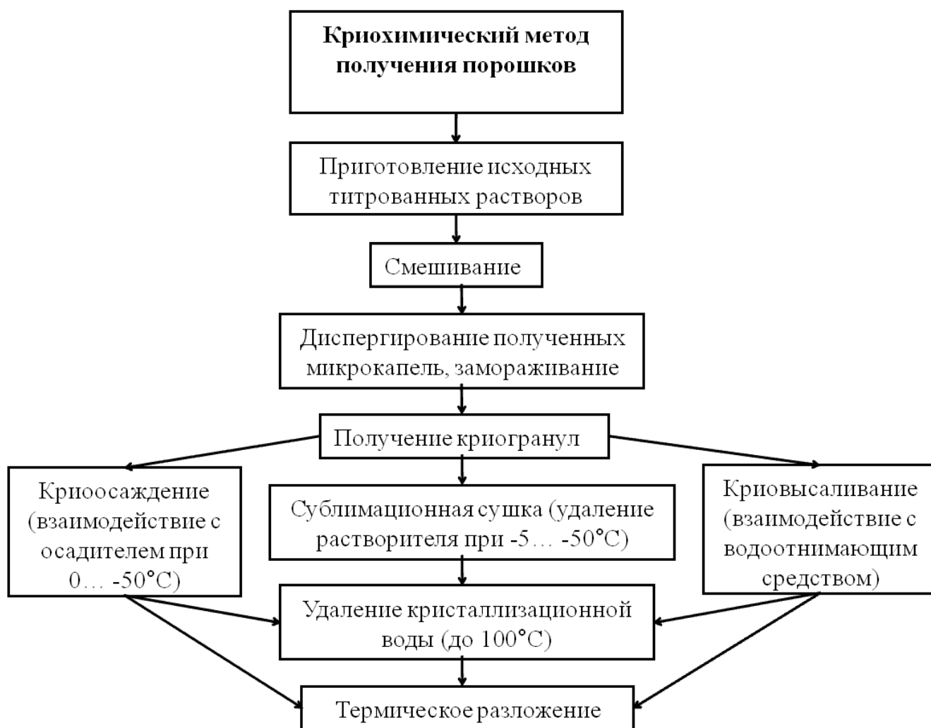
Рисунок 1.2. Схема синтеза нанопорошков криохимическим методом
