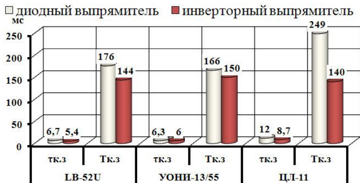
Рисунок 4 – Диаграммы зависимости усредненного времени короткого замыкания дугового промежутка \tau_{к.з} , времени полного цикла образования и переноса капли T_{к.з} от типа источника питания
