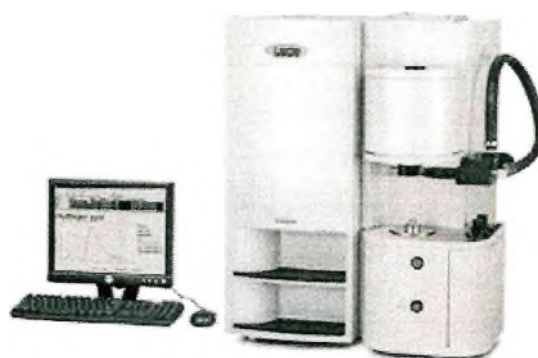
Рисунок. 5. Газоанализатор RHEN 602 для измерения абсолютной концентрации водорода
