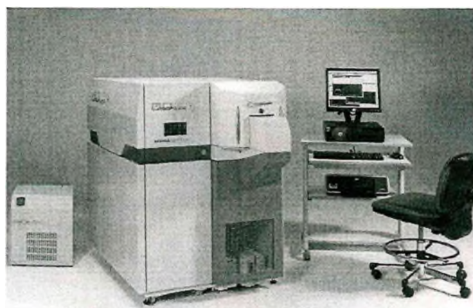
Рисунок 6. Установка Profiler 2 для измерения оптических спектров методом радиочастотного тлеющего разряда.
