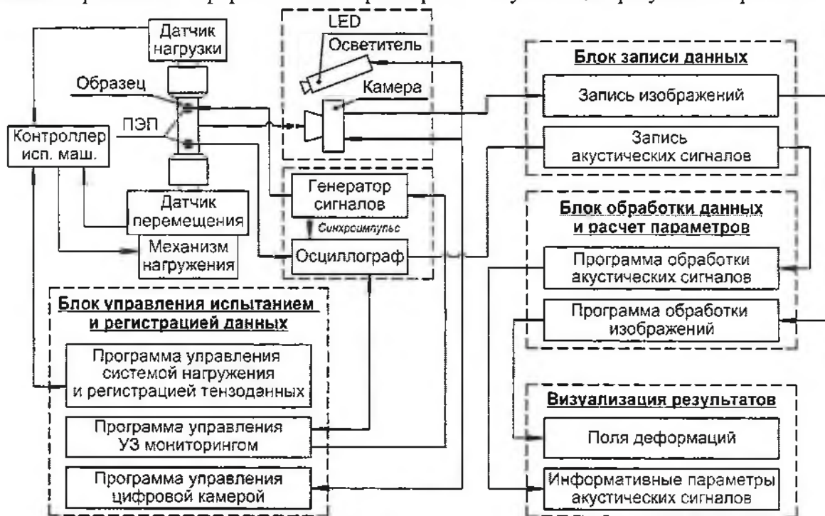
Рисунок 1 – Функциональная схема разработанного комплекса для мониторинга состояния материалов с использованием комбинированного акустико-оптического метода.
